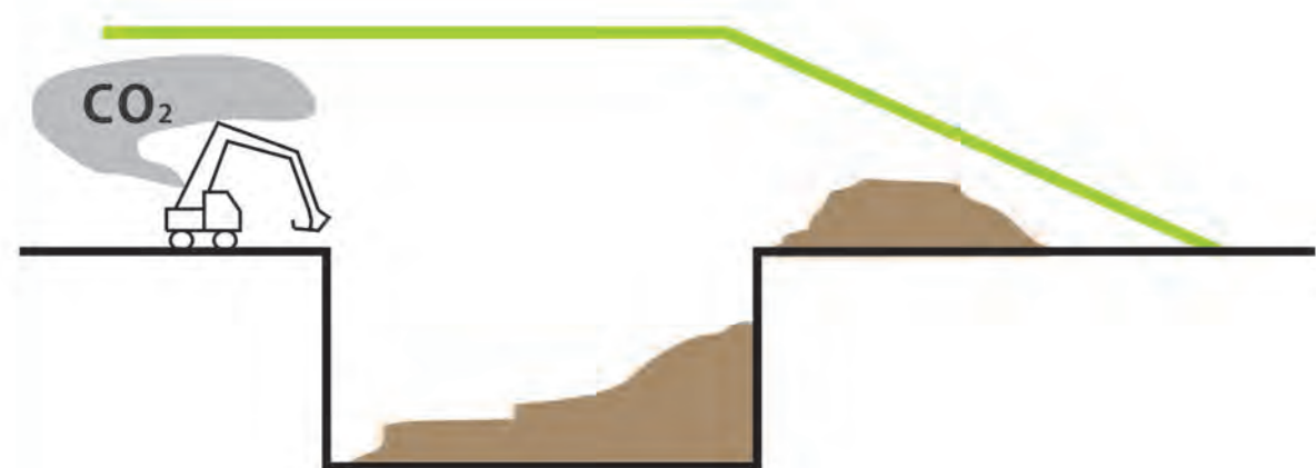
開挖地下室時，地面上先行建設能將二氧化碳部分吸收的綠藻板
